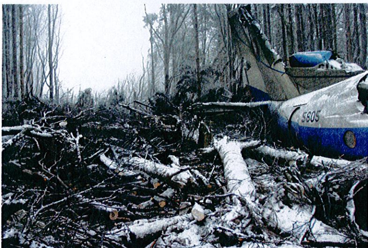
obr. č. 14 Zadná časť trupu a časť prieseku
