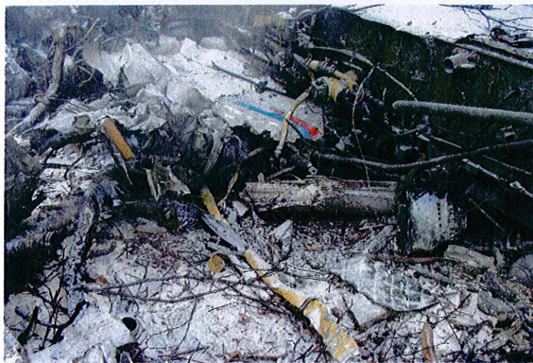
obr. č. 18 Zvyšky centroplánu s palivovým potrubím
