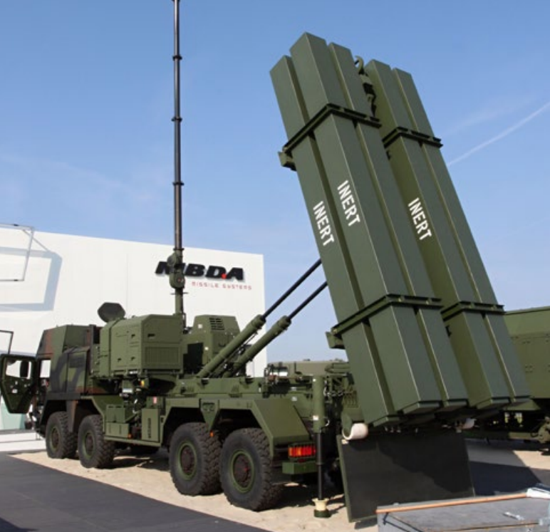
MEADS – OZ – Samohybné odpaľovacie zariadenie vyvíjaného protiletadlového raketového systému MEADS
