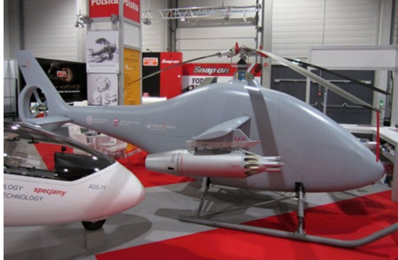
ILX-27 – Bezposádkový vrtuľník ILX-27 môže pod každú polovicu krátkého krídla podvesiť blok s neriadenými protizemnými raketami
