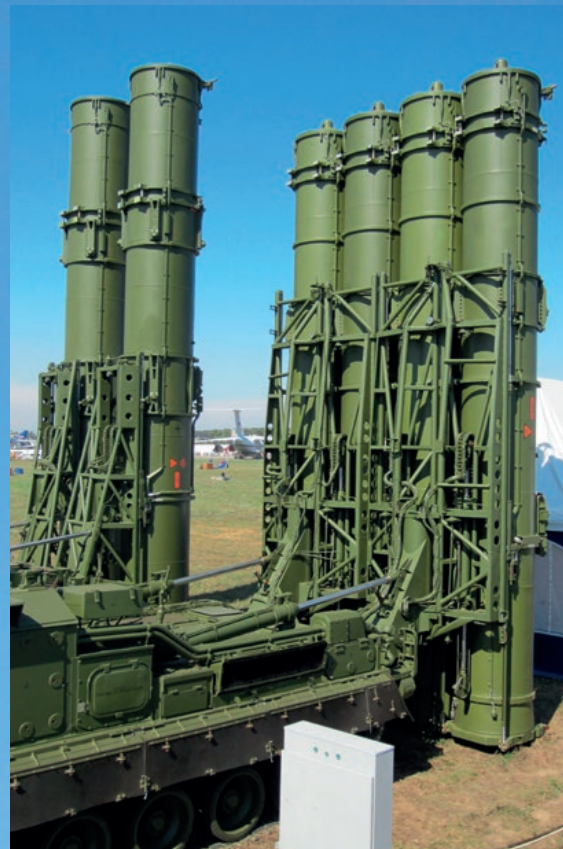
Čiastočný pohľad na odpaľovacie zariadenie 9A83ME (vpredu so štyrmi kontajnermi) a prebíjaco-odpaľovacie zariadenie 9A84ME (vzadu s dvomi kontajnermi). Vozidlo 9A84ME nedisponuje radarovým ožarovačom, ale je vybavené žeriovom.
